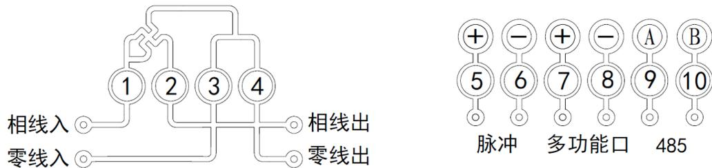
图 3 DDSF6606vcp 接线图
